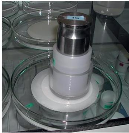
圖 A.2 壓力下吸收率之量測裝置示例
