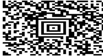
圖 A.5 Aztec Code 之固定圖樣損壞符號
