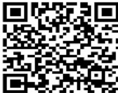
圖 A.4 具固定圖樣損壞之 QRCode 符號
